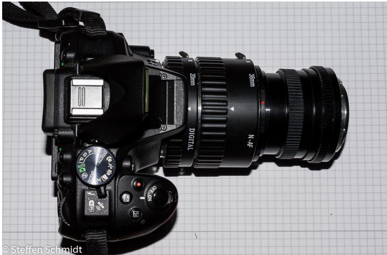
Abbildung 3: Die Zwischenringe werden mit dem Bajonett an die Kamera gestöpselt (hier eine Nikon, aufs Bajonett achten!) und darauf folgen der Retroadapter und das Objektiv in Retro-Stellung (falsch herum...)
