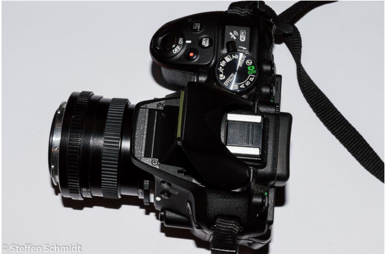
Abbildung 13: Aufbau ohne Zwischenringe. Der Retroadapter wird ans Kamerabajonett geschraubt und das Objektiv an das vom Adapter bereitgestellte Filtergewinde. Bei 28 mm Brennweite erreicht man etwa den doppelten Abbildungsmaßstab eines Makroobjektivs.
