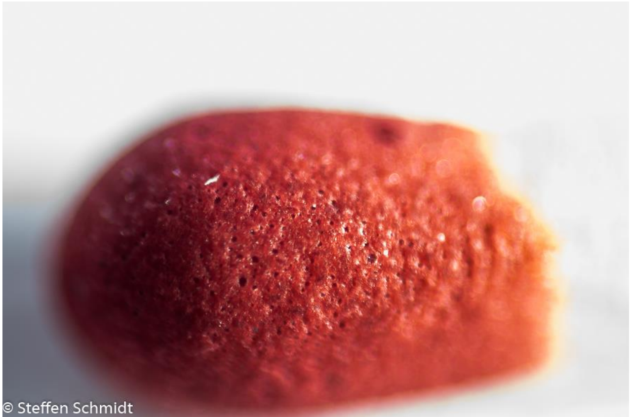
Abbildung 7: f/2.8 , unbeschnitten. Die Tiefenschärfe ist nun kleiner als 0.05 mm. Dort, wo der Fokuspunkt sitzt, ist es scharf, jedoch weniger als bei f/8 . Hier limitiert das Objektiv die maximale Schärfe. Bild ist bearbeitet – Bearbeitungsziel: Maximale Informationen.
