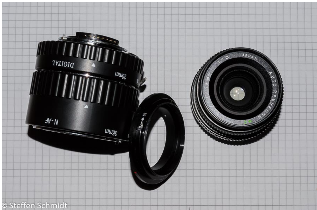
Abbildung 2: Von links nach rechts: Zwischenringe, Retroadapter mit passendem Gewindedurchmesser, analoges Weitwinkelobjektiv (hier ein f/2.8, 28 mm Brennweite mit 49 mm Gewindedurchmesser)
