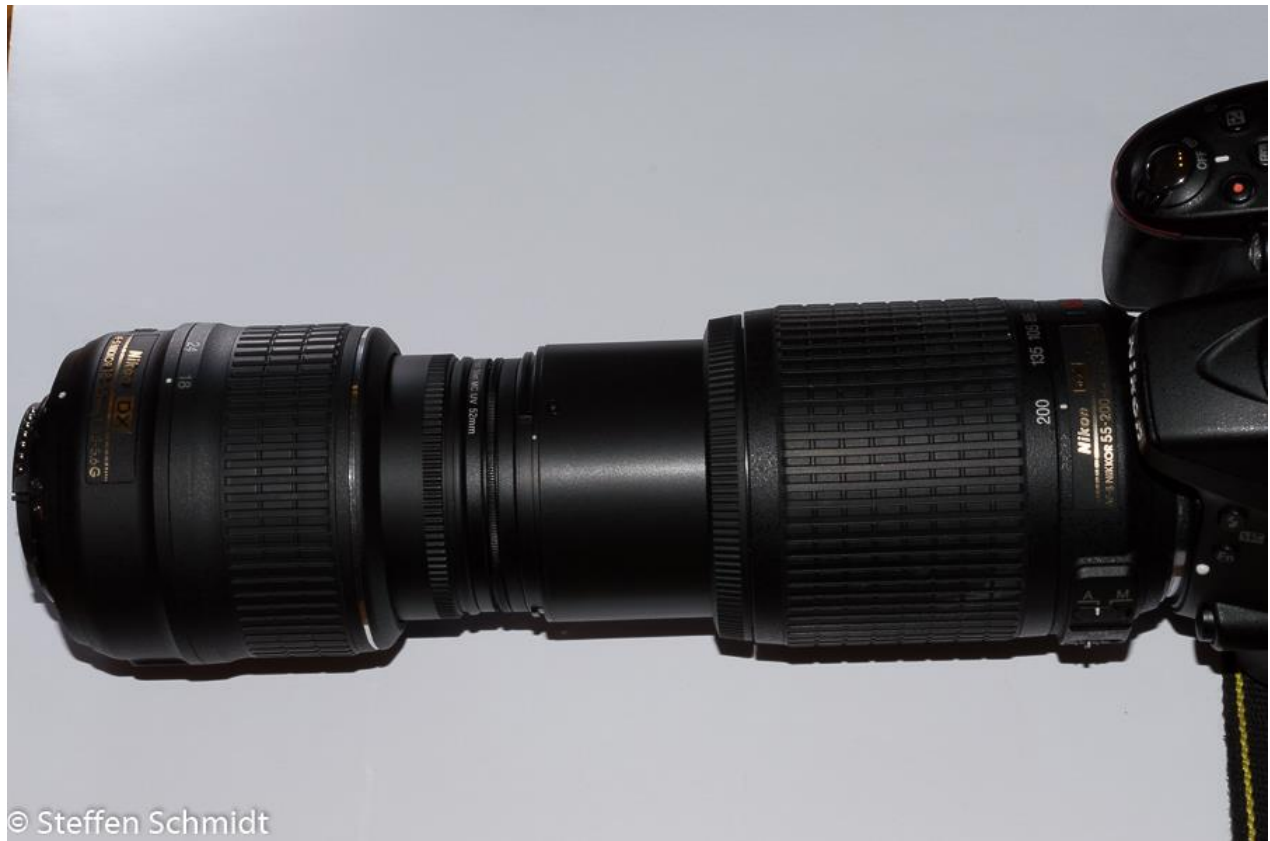
Abbildung 15: „Freak-Konstruktion“ mit Tele und Weitwinkel (in Retro), verbunden durch einen Umkehrring. Abbildungsmaßstäbe variabel von ca. 1:1 bis ca. 10:1.
